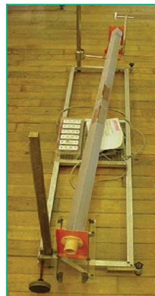
Fig.1 : Oscillateur mécanique sur banc à coussin d'air
