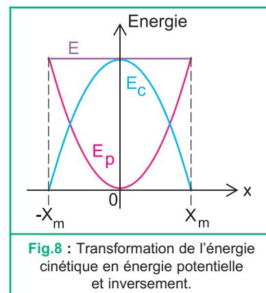
**Fig.8** : Transformation de l'énergie cinétique en énergie potentielle et inversement.
