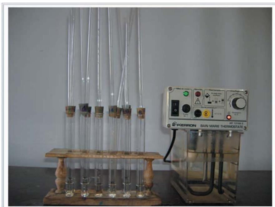
Nous avons vu que pour chaque système contenant au départ un acide et un alcool ou un ester et de l'eau, en présence d'un catalyseur approprié et à la température de  $80^{\circ}\text{C}$ , il se produit à notre échelle soit une estérification spontanée pour le premier système, soit une hydrolyse spontanée pour le second.
