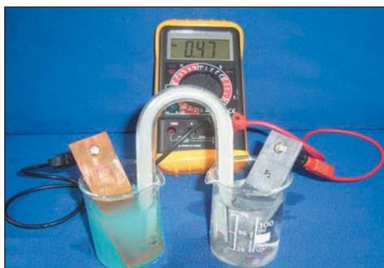
a) Mesure de la f.é.m. de la pile ( $P_b$ ) avant dilution.
