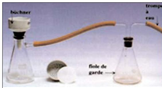
**Figure 5.** Dispositif de filtration.
