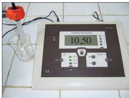
Mesure du pH de la solution d'ammoniac 5 \cdot 10^{-3} M.
