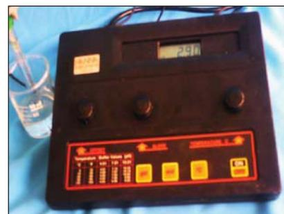
Figure 4. Mesure du pH d'une solution d'acide éthanóique.
