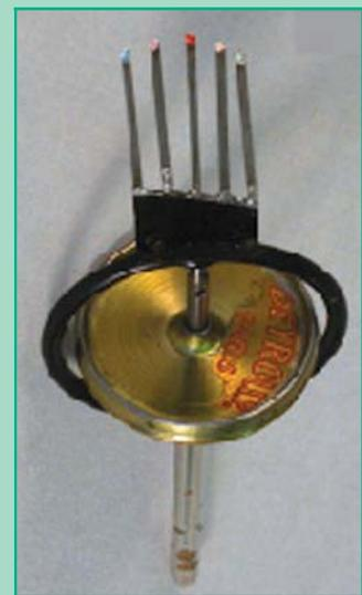
Fig.10 : Gyroscope à lames
