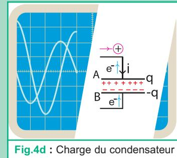
Fig.4d : Charge du condensateur
