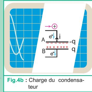
Fig.4b : Charge du condensateur
