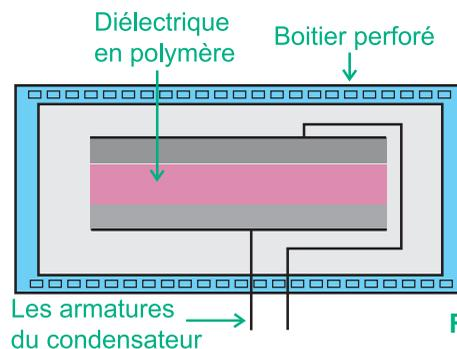
Cette variation d'humidité entraîne une variation de la fréquence propre du circuit RLC série dans lequel le condensateur est inséré.(Fig.2)
