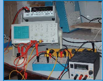
Fig.2b : Montage d'étude d'un dipôle à résistance négative
