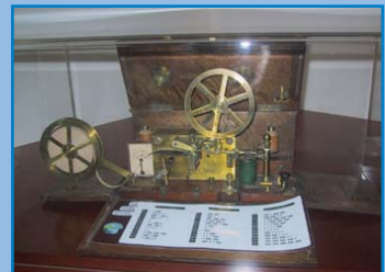
Fig.1 : Télégraphe électrique de Morse(1837)
