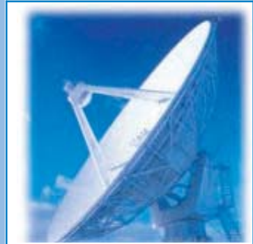
Fig.20 : Paraboloïde pour communication via satellite
