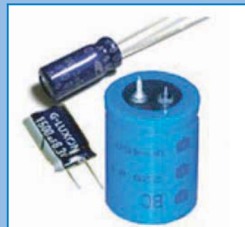
Fig.2 : Quelques condensateurs usuels
