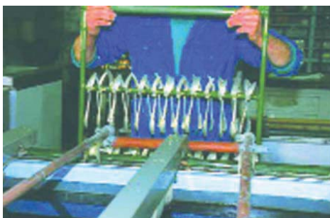
Figure 7. Argenture de cuillères à soupe par électrolyse à anode soluble
